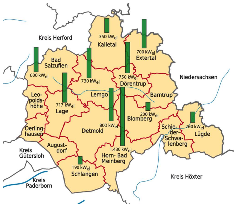
Abbildung 15: Übersicht über die Leistungsverteilung im Kreisgebiet 17
