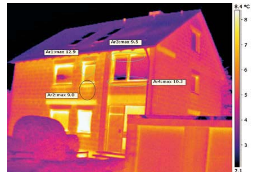
Ar1, Ar3: Wärmeverluste durch Undichtigkeit am Fensterrahmen, Ar2: Wärmeverluste durch Heizkörpernische
