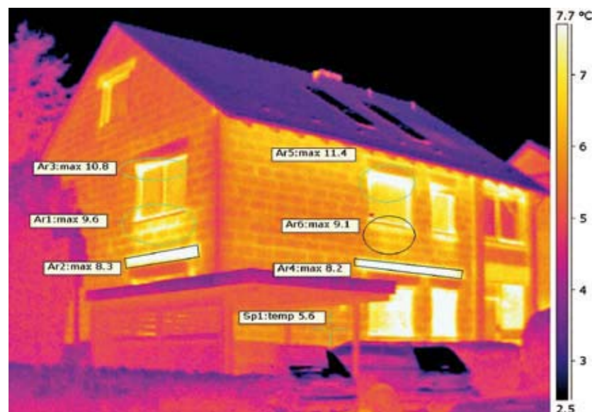
Ar1, Ar6: Wärmeverluste durch Heizkörpernischen, Ar3, Ar5: Wärmeverluste durch Fensterrahmen, Ar2, Ar4: Wärmeverluste durch Rollladenkästen
